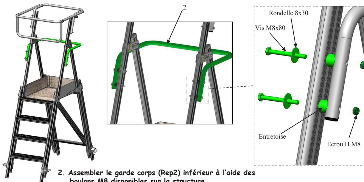
2. Assembler le garde corps (Rep2) inférieur à l'aide des boulons M8 disponibles sur la structure.
