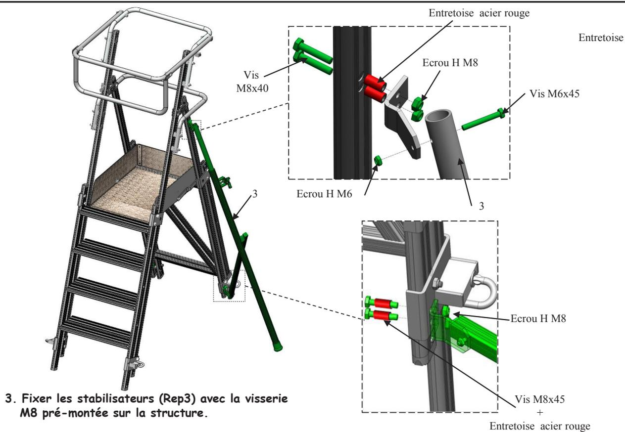
3. Fixer les stabilisateurs (Rep3) avec la visserie M8 pré-montée sur la structure.
