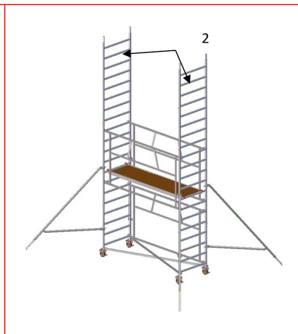
**3.** Installer les deux cadres supérieurs (rep.9) puis positionner le plancher à trappe (rep.6)
