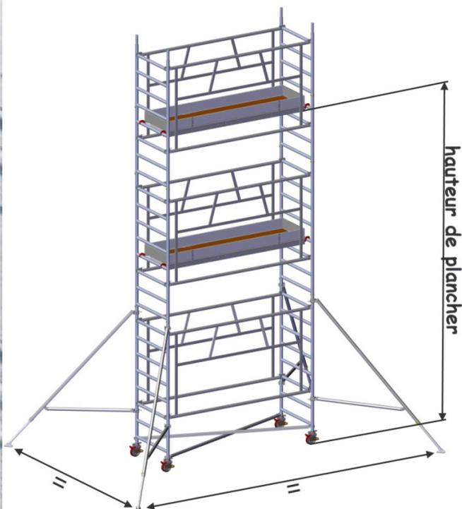
**7.** Contrôler le calage de l'échafaudage roulant en vérifiant que les stabilisateurs (rep.5) soient à égale distance dans le sens latéral et longitudinal. S'assurer du verrouillage correct des cadres.
