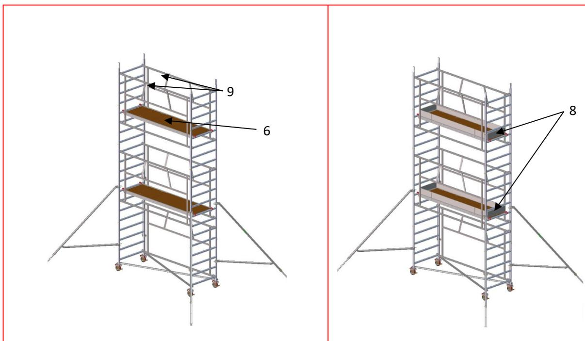
**5.** Installer les deux cadres supérieurs (rep.9) puis positionner le plancher à trappe (rep.6)
