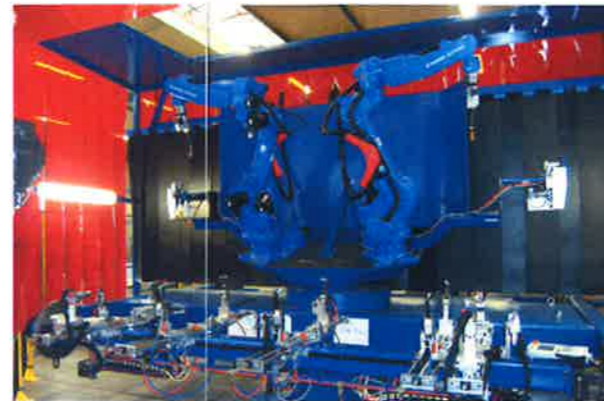
Opération de soudage sur un plancher d'échafaudage
